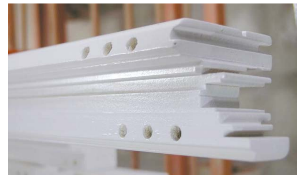
Vsi sestavni elementi okenskega okvirja so v celoti površinsko obdelani pred lepljenjem.
